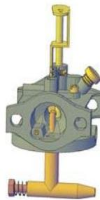
Gambar 3. Desain karburator dengan katup biogas
